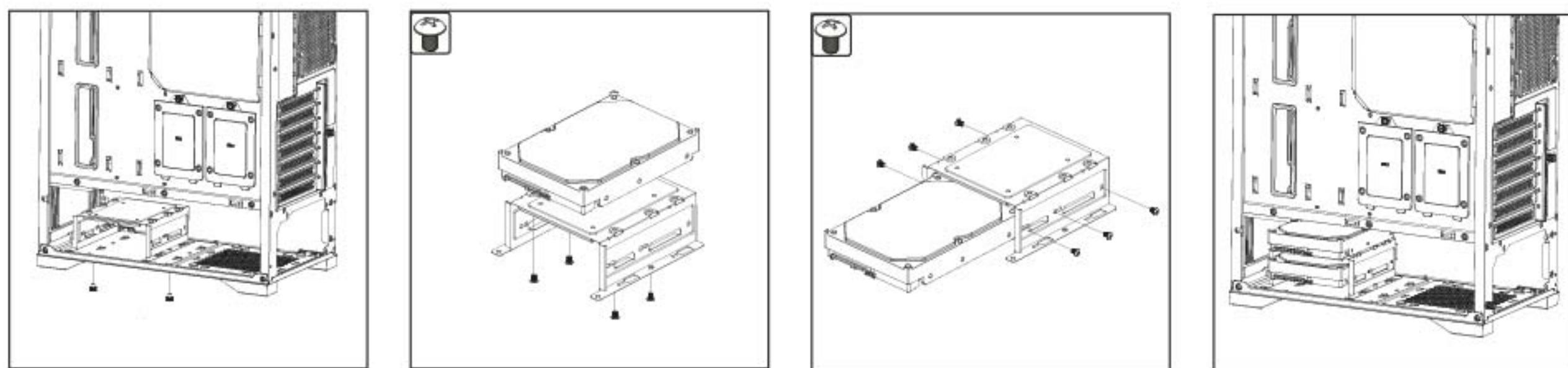
Installing 2.5" SSDs / Montaż dysków 2.5" SSD
